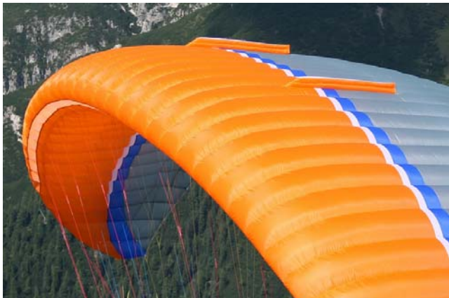
Streamline Technology und Sharkfins – Nach umfangreichen Testreihen wird die Entwicklung erstmals beim UP Ascent in der Serie eingesetzt
