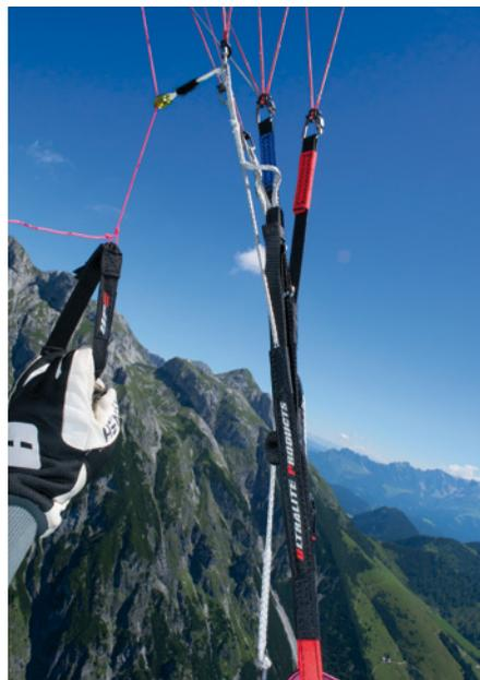
Der Leichttragegurt des Kibo im Flug. Gut zu sehen: die gewichtsreduzierte C-Ebene mit Öse und Klett für die Bremse.
