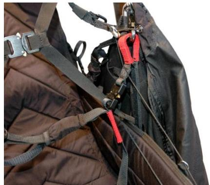
Die Länge der Verschlussleine wird so eingestellt, dass die Nase des Beinsacks beim Startlauf nicht den Boden berührt und der Beinsack beim Flug mit gestreckten Beinen sauber geschlossen ist.
