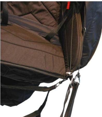
Links wird die Leine erst durch die Rolle und dann von innen durch die Oese des Beinsacks geführt und mit der Plasticschnalle verknötet.
