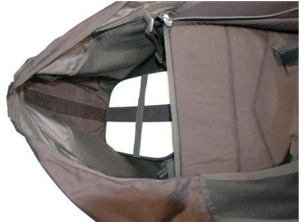
Jetzt das Gurtband der Fußplatte durch die Stegschnalle schlaufen und zur Fixierung wieder nach unten führen. Es sollte nach erfolgter Einstellung in Flugposition leicht unter Spannung sein. Der Gummizug der Fußplatte wird mittels Delta-Karabiner mit der Verschlussleine des Beinsacks verbunden.
