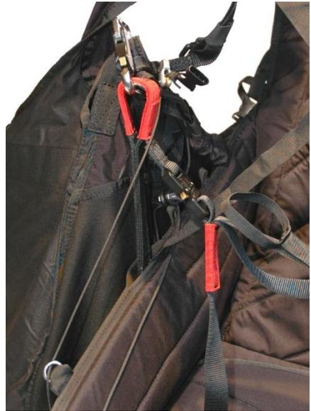
Die Verschlussleine wird durch die seitlichen Metallringe zu den kleinen Rollen der Schultergurte geführt.
