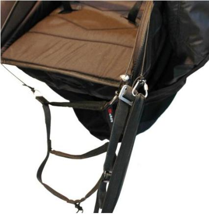
Rechts (Flugrichtung) wird die Verschlussleine durch die Metallrolle geführt und direkt mit der Plasticschnalle verknötet.
