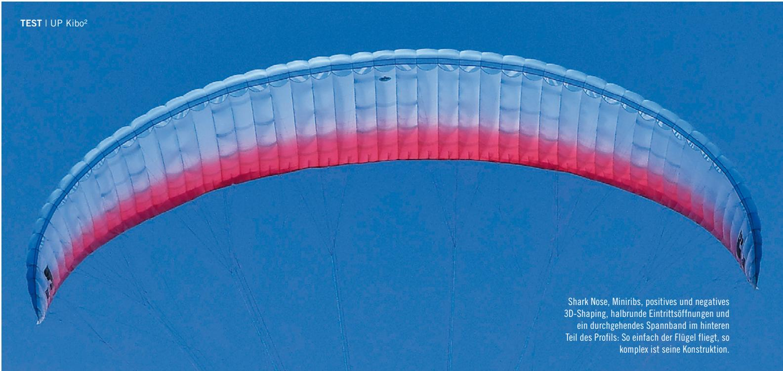
Shark Nose, Miniribs, positives und negatives 3D-Shaping, halbrunde Eintrittsöffnungen und ein durchgehendes Spannband im hinteren Teil des Profils: So einfach der Flügel fliegt, so komplex ist seine Konstruktion.
