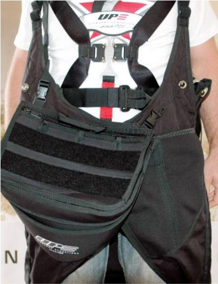
Die Leinen des Beschleunigers werden durch die kleinen Öffnungen unter der Neoprenabdeckung nach außen geführt.
