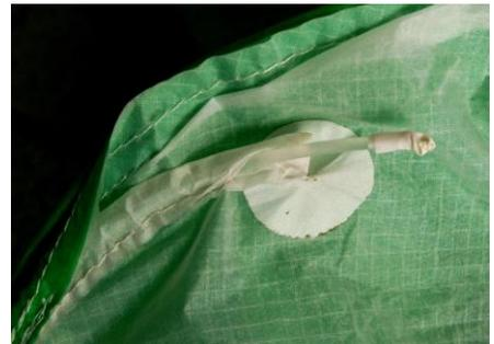
Dazu schiebt man das Stäbchen etwas zurück bis es aus der Tasche gleitet. Anschließend zieht man es heraus und überträgt die Länge exakt auf das Ersatzmaterial. Bevor der neue Stab eingesetzt werden kann, müssen seine Enden abgerundet und mit Gewebeband abgeklebt werden. Beim Einschieben muss man darauf achten, dass das Stäbchen wieder hinter die kleine Nähkante rutscht. Nur dann ist es in der Tasche arretiert.
